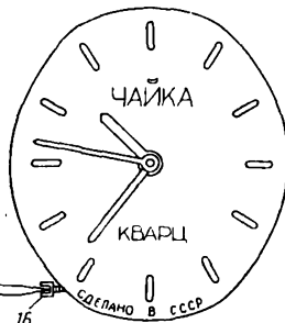
Рис. 69 13 – стрелка секундная; 14 – стрелка минутная; 15 – стрелка часовая; 16 – винт циферблата; 17 – циферблат Примечание: винт крепления циферблата от- вернуть на 1,5–2 оборота и после снятия цифер- блата довернуть винт до упора.
