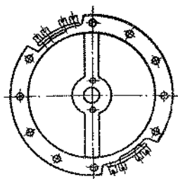
Фиг. 99. Баланс с приставными биметаллическими дугами.
