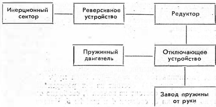
Рис. 37. Принципиальная схема механизма автоматического подзавода пружины наручных часов
