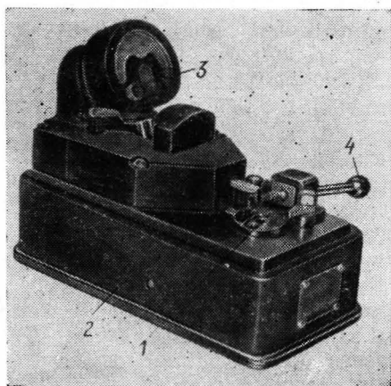
Рис. 191. Прибор для установки осевого зазора баланса:
