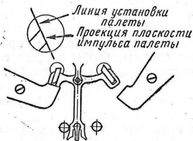
Рис. 167. Установка палеты по плоскости импульса.
