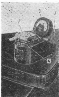
Рис. 177. Прибор для проверки осевого зазора центрального триба:
