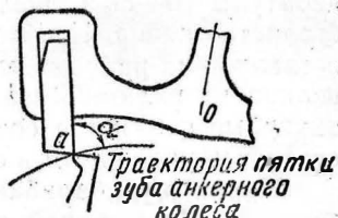
Рис. 168. Установка палеты по траектории пятки зуба анкерного колеса
