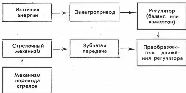
Рис. 59. Принципиальная схема наручных электронно-механических часов нормального калибра
