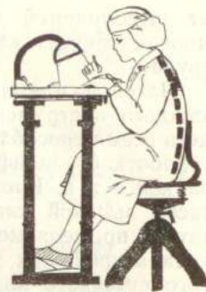
Рис. 44. Правильное положение часовщика во время работы
