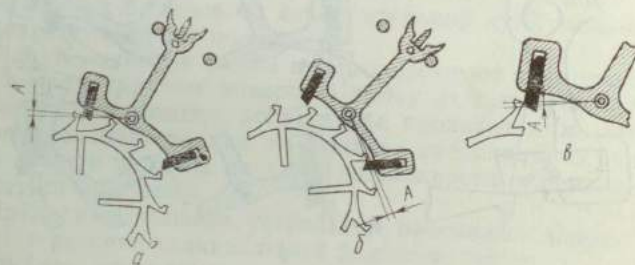
Рис. 22. Углы покоя: а — угол полного покоя на входной палете; б — угол полного покоя на выходной палете; в — определение угла покоя по положению острия зуба на плоскости покоя палеты
