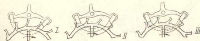
Рис. 17. Разновидности анкерной вилки: I — равноплечая; II — полуравноплечая; III — неравноплечая
