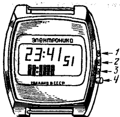
Рис. 183. Часы «Электроника» 30350 (Б6-202): 1 — кнопка коррекции часов; 2 — кнопка коррекции минут; 3 — кнопка установки секунд; 4 — кнопка вызова показаний числа месяца и месяца
