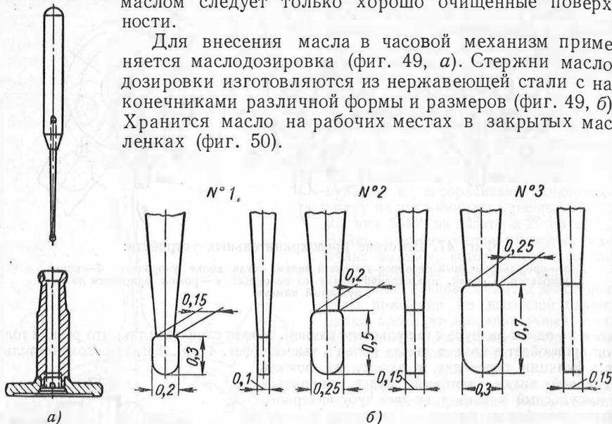
Фиг. 49. Инструмент для смазки механизма:
