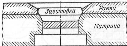
Фиг. 28. Схема обжимки.
