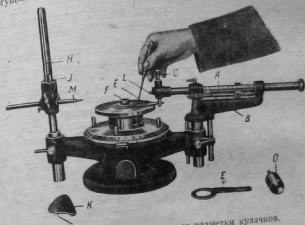
Фиг. 111. Прибор Бехлер для разметки кулачков.
