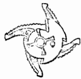
Фиг. 206. Минутник часов с боем.
