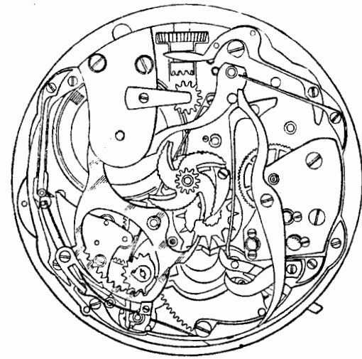
Фиг. 195. Минутный репетир, собранный до четвертного репетира.
