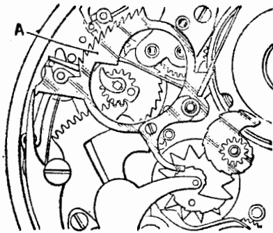
Фиг. 192. Гребенка (А) пятиминутного репетира.
