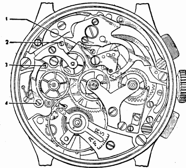
Фиг. 122. Хронограф без колонного колеса. Цифрами показаны винты с эксцентричными уступами.
