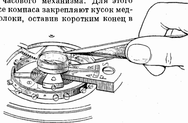
Фиг. 419. Испытание компасом намагниченности механизма часов.
