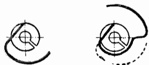
Фиг. 194. Корректировка точки заштыфтовки посредством изгиба спирали.
