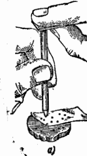
Фиг. 152. Изготовление шайб.
