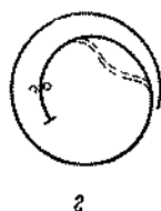
Рис. 93. Ошибки, вызванные смещением точки заштыфтовки
