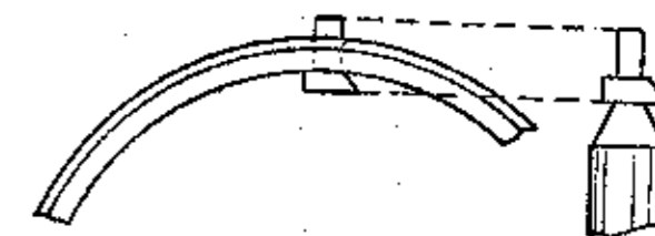
Фиг. 22. Крючок барабана для пружины.
