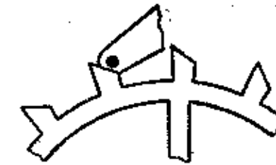
Фиг. 85. Анкерное колесо с зубцами клиновидной формы.
