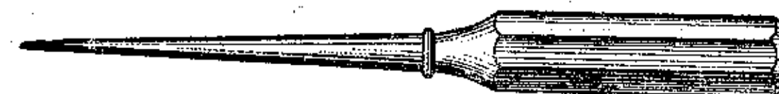
Фиг. 105. Инструмент для доводки стянутого отверстия.
