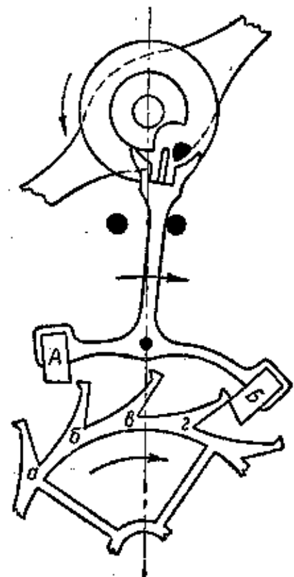
Фиг. 95. Дополнительная дуга, проходящая балансом.
