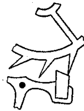
Фиг. 84. Анкерное колесо с острыми зубцами.
