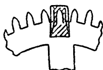
Рис. 112. Вставка зуба в колесо (1-й способ)
