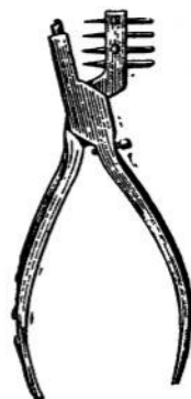
Рис. 27. Щипцы для прокалывания отверстий в пружинах
