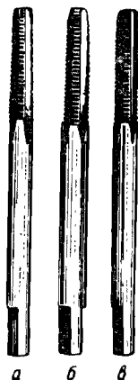
Рис. 12. Мітчики: а, б — попередня (чорнова) нарізка, в — чистова.
