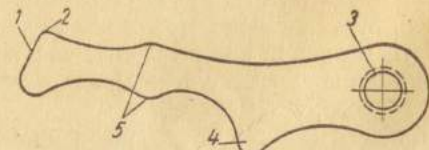
Фиг. 2.29. Заводной рычаг: 1 — плоскость скольжения; 2 — мысик фиксации; 3 — цилиндрическое отверстие; 4 — мысик под заводную пружинку; 5 — двояковыпуклая часть.
