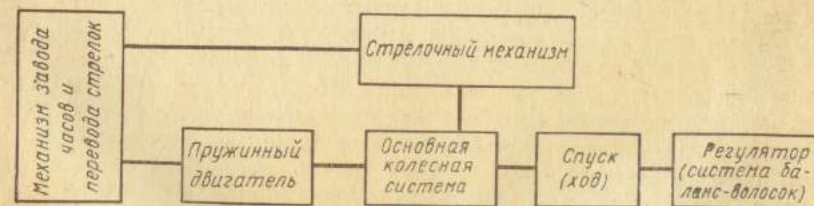
Фиг. 1.2. Принципиальная схема механизма современных часов.
