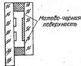
Рис. 3.4. Схема чернения стеклянной пластины
