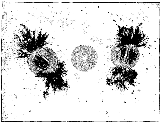
Рис. 395. Спирали стальные и элинварная после намагничивания.
