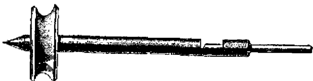
Рис. 153. Спица с ролькой для сверла.
