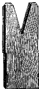
Рис. 243. Подставка для ручного вельцования.
