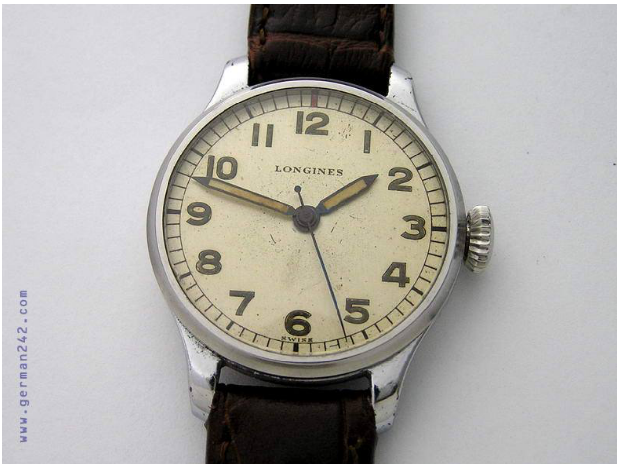
LONGINES военного типа, 1942 год. Фирма дорогая, в краску радия не жалели, около 2000 мкр/час !!!
