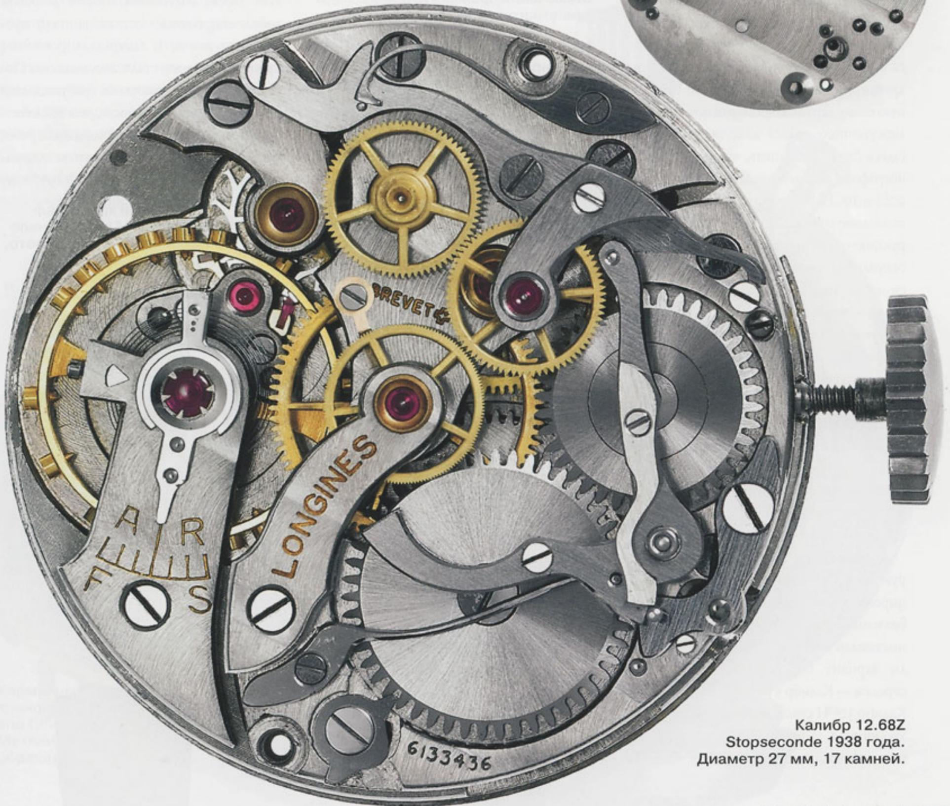
Калибр 12.68Z Stopseconde 1938 года. Диаметр 27 мм, 17 камней.
