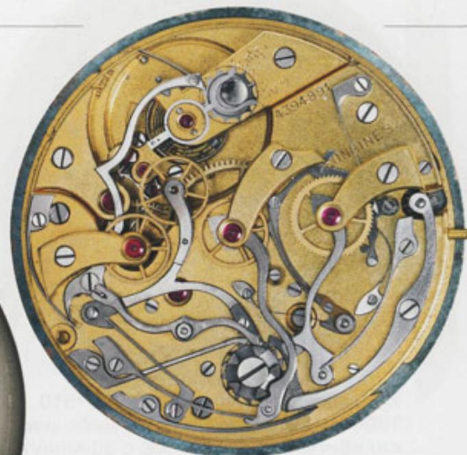
Калибр 19.73N с высокочастотным балансом для 0,01-секундного секундомера.
