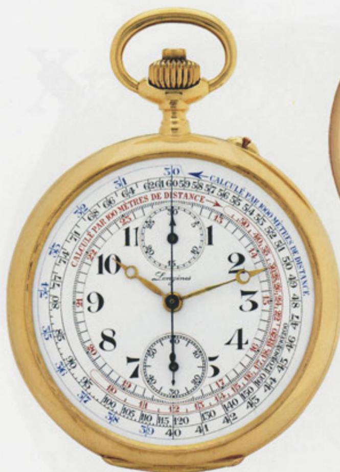
Хронограф 1920-х годов. Золото, механизм Калибр 19.73, хронограф с 30-минутным счётчиком и двумя тахиметрическими шкалами: первая рассчитана исходя из дистанции в 1 км (синий и чёрный витки), вторая — 100 метров (красный виток).
