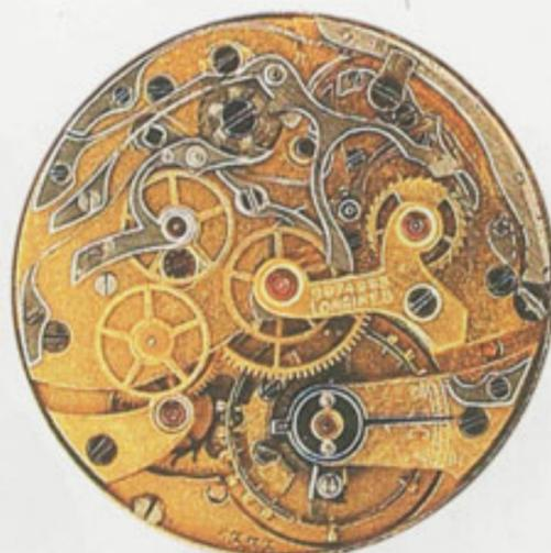
Калибр 13.33Z — второй вариант, управление кнопкой на заводной головке.
