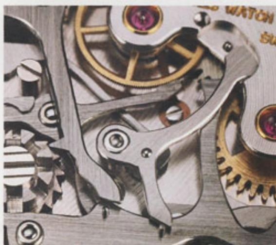
Устройство вертикального отключения промежуточного колеса минутного счётчика Калибра 30СН.
