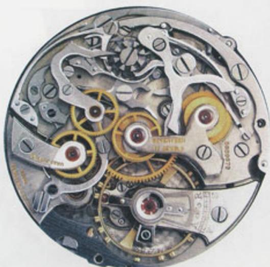
Калибр 13ZN с возвратной функцией, центральным минутным и дополнительным 12-часовым счётчиками.
