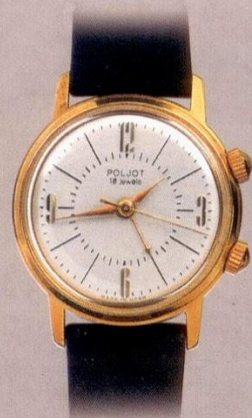
«Сигнал» 2612, часы со звуковым сигналом. Калибр 26 мм, высота механизма 5,8 мм, 18 камней. Выпускались с 1959 по 1978 г., затем заменены на модификацию 2612.1.
