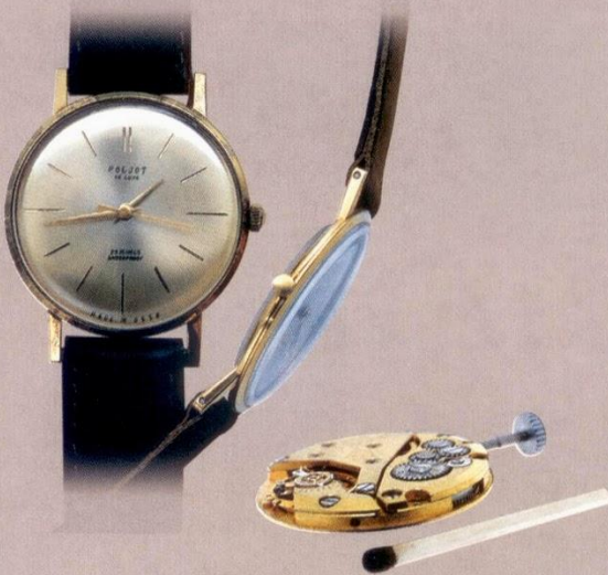
«Полет» 2209 и 2200. Первые в стране особо плоские часы. Высота механизма 2,9 мм и 1,85 мм соответственно, высота корпуса 5 и 3,8 мм. Выпускались с 1961 по 1979 г.
