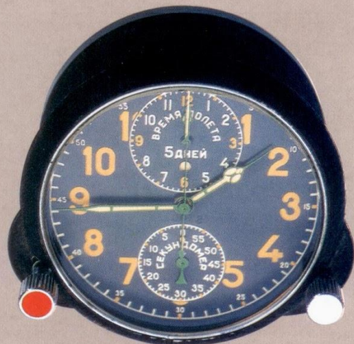
«АЧ», авиационные часы-хронограф с секундометром и механизмом отсчета времени полета. Продолжительность хода от одной заводки пружины 120 часов. Температурный интервал безотказной работы от -60 С до +50 С. Различные модификации выпускаются с 1933 года.
