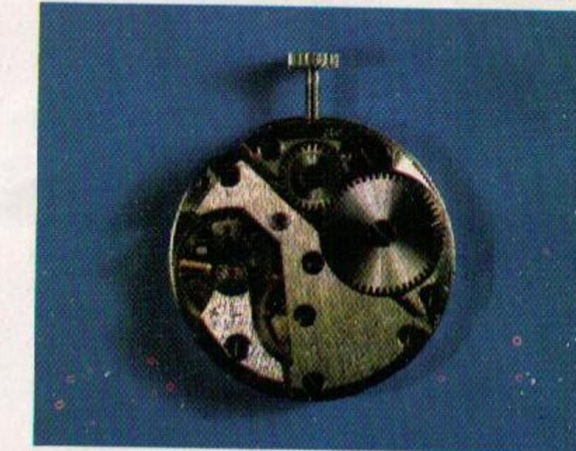
Werkkaliber 26 mm, Werkhöhe 3,98 mm, 19 Rubinsteinne, Ankerhemmung, Zentrumssekunde, Stoßsicherung der Unruhwelle.
