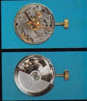
Калибр механизма 18 мм, 21 рубиновый камень, стальной анкерный ход, период колебания баланса 0,33 с, центральная секундная стрелка, автоподзавод и противоударное устройство оси баланса, пружина из нержавеющей стали, продолжительность хода часов от одной полной заводки пружины 36 ч.
