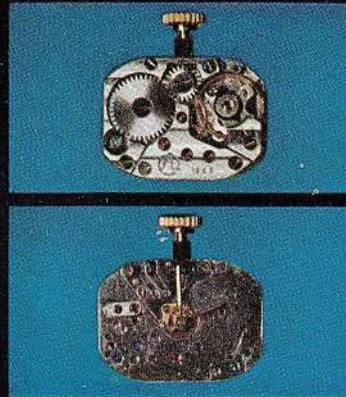
Калибр механизма 18 мм, 16 рубиновых камней, стальной анкерный ход, период колебания баланса 0,33 с, продолжительность хода часов от одной полной заводки пружины 36 ч.
