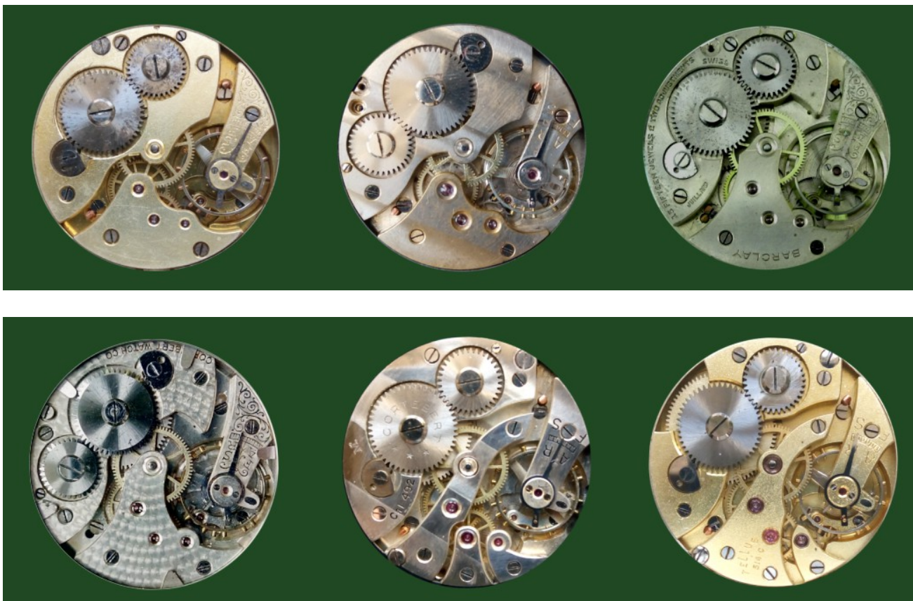
Механизмы Cortebert 488, 489, 490 (Barclay), 491, 492, 514 (Tellus 514C), семейство C488, 1920-1930 годы
