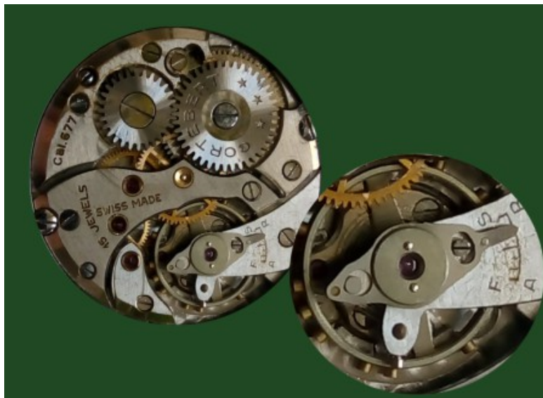
Калибр Cortebert 677 с устройством Spirofix
